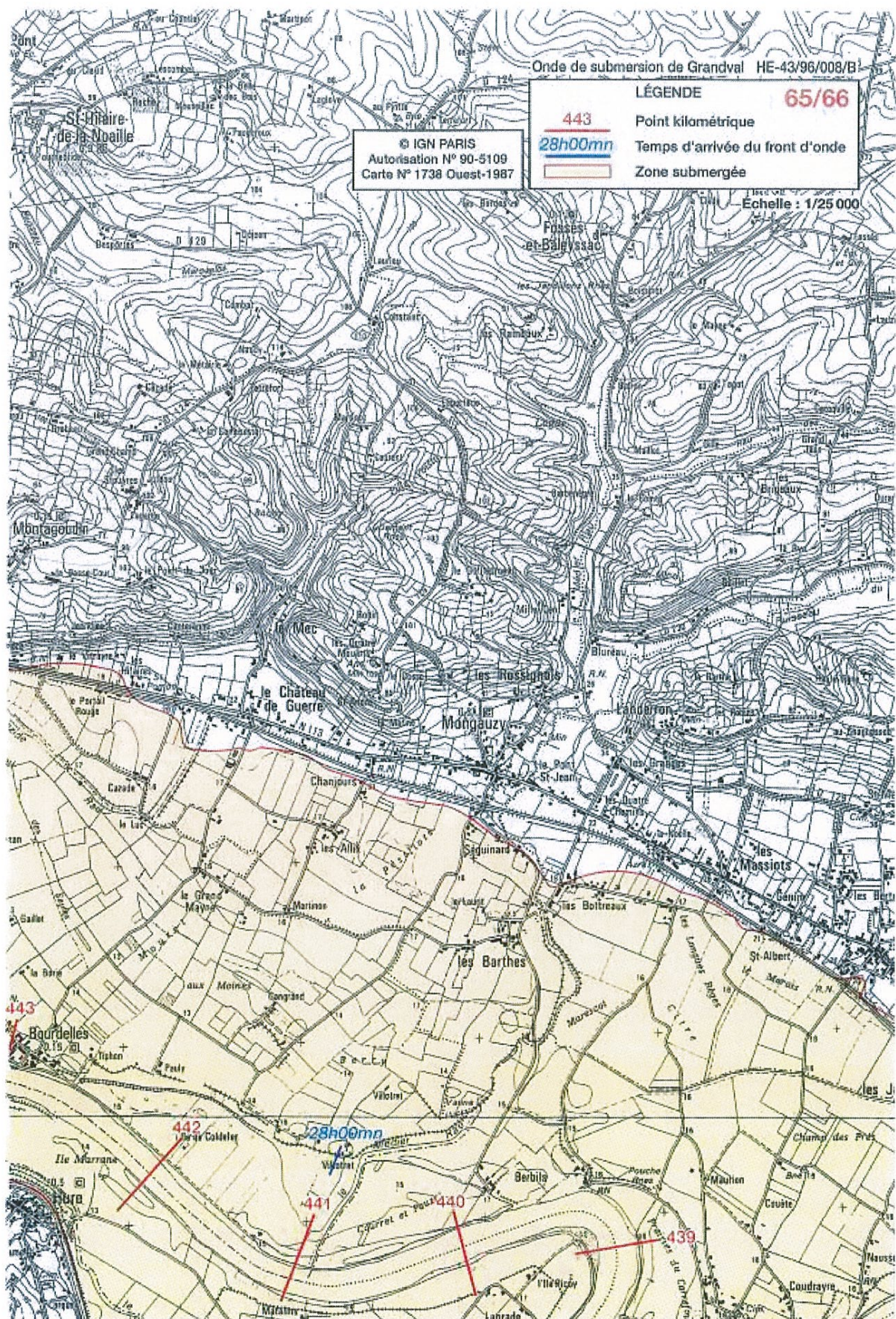
(Source : Rapport relatif à l'onde de submersion à l'aval du barrage de Grandval, réalisé par EDF, en décembre 1996)
